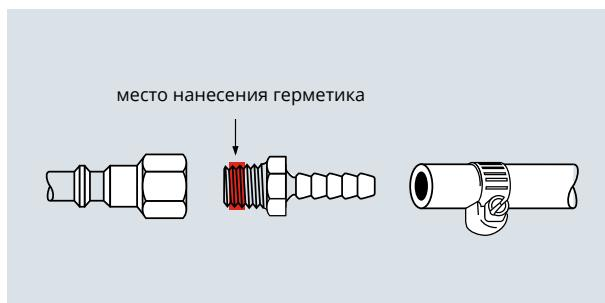
1. Обезжирить резьбу очистителем Loctite® SF 7063 и дать растворителю испариться. При необходимости, обработать активатором Loctite® SF 7649, дать высохнуть.
